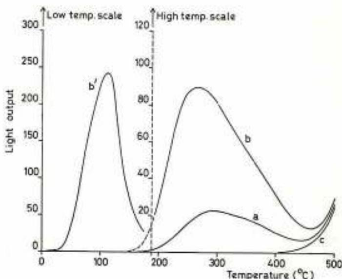
Figura 38: Curvas TL de luminosidad para el cuarzo extraído del fragmento a 7: (a) TL Natural, (b) TL Natural + TL inducida por una radiación beta adicional aplicada en el laboratorio de 230 rad, (c) luminosidad candente de fondo.
